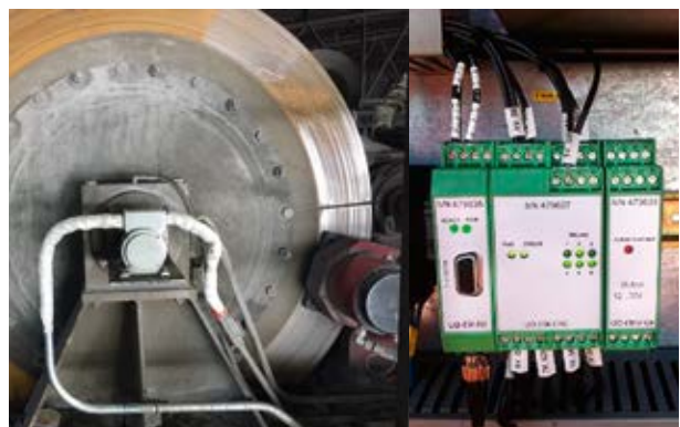
Nachher: Direktanbau des U-ONE-Basisgeräts mit Elektronikmodulen im Schaltschrank / After: Direct mounted U-ONE basic unit with electronic modules in the switchboard
