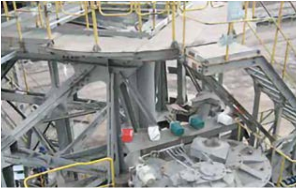
Vorher: Positionsüberwachung mit mehreren mechanischen Kopierwerken/ Before: Position monitoring with several mechanical cam limit switches
