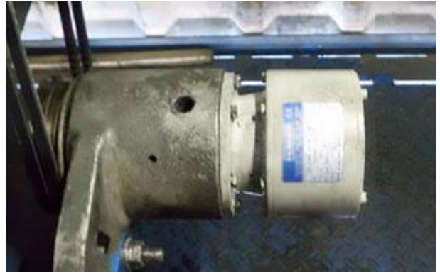
Nachher: Inkrementaler Drehgeber mit elektronischem Grenzdrehzahlschalter
