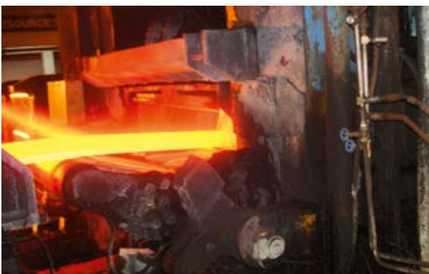
Vorher: Schlingenheber im Walzgerüst / Before: Looper in roll stand
