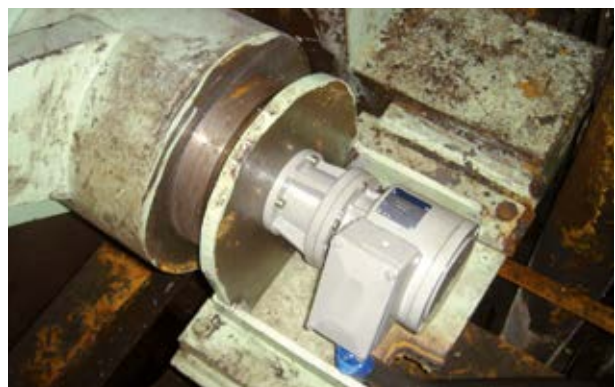
Nachher: Looper-Drehgeber / After: Looper encoder
